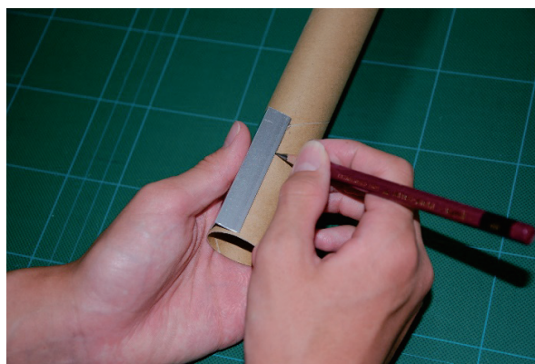
写真8 アルミニウムアングルの活用
